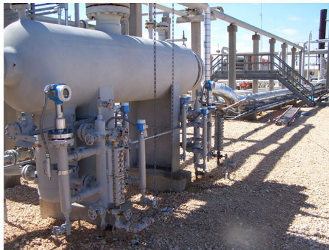
Separator woda/węglowodory po modernizacji pomiaru poziomu i rozdzieleniu warstw z użyciem radarów Levelflex
